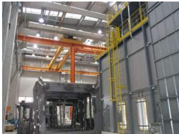
Lakirnica tvrtke Eko Međimurje zauzima površinu od 1700 četvornih metara unutar koje se nalaze dvije linije za lakiranje i komora za odmašćivanje.
